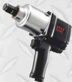
Art. NC-6215 Klucz udarowy 3/4" 1220 Nm, kg 4,5 kg
