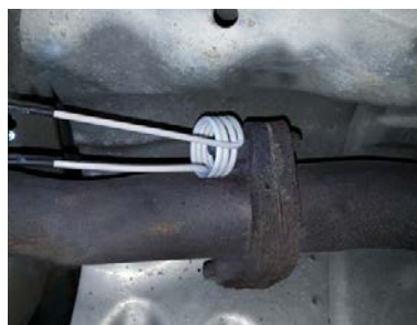
Smontaggio marmitte Disassembling mufflers Desmontaje de silenciadores
