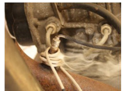
Riscaldamento sonda Lambda Heating of Lambda Sensor Calentamiento del sensor Lambda
