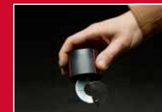
POWTÓRZENIE - Zwolnij urządzenie, usuń urobek i powtórz całą pracę na kolejnym otworze
