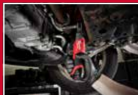
Pneumatyczna grzechotka z maksymalnym momentem obrotowym 75 Nm
