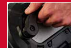
Mechanizm blokowania ostrza bez użycia narzędzi
