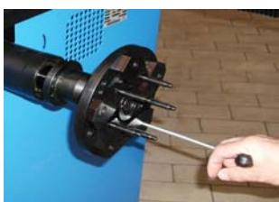
Ausleger lösen und Zentrierring montieren
