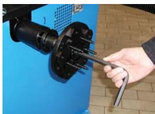
UNI-LUG am Flansch montieren
