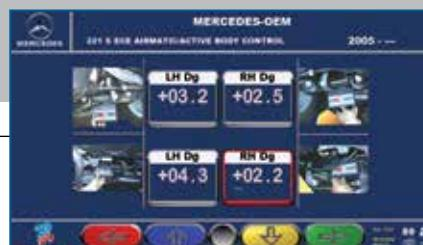
La banca dati modifica automaticamente le specifiche di assetto in funzione dell'altezza del telaio.
