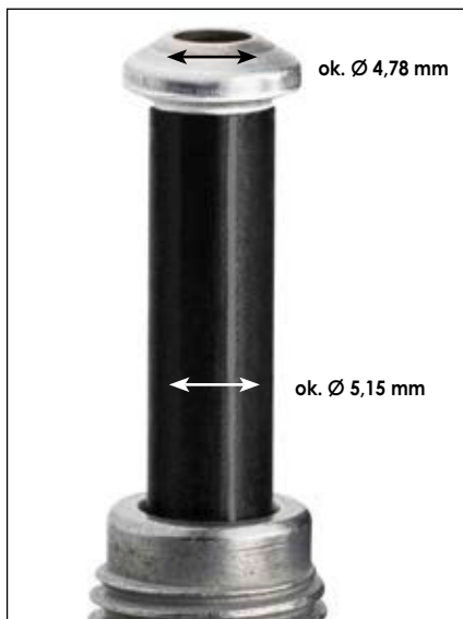
Przewód hamulcowy nowej generacji
