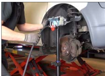
2. Naciąganie sprężyn bezpośrednio na pojeździe
