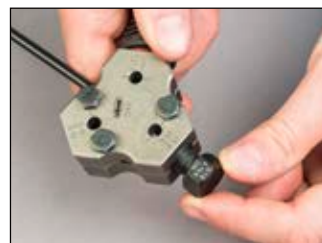
Formowanie końcówki przewodu DIN
