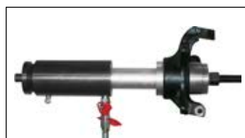
Montaż łożyska koła
