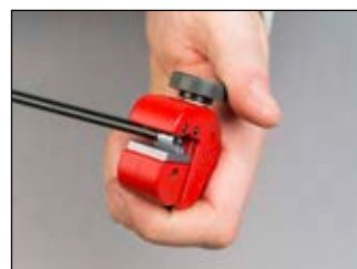
Pozycjonowanie przewodu w celu zeszkobania płaszczka z tworzywa sztucznego
