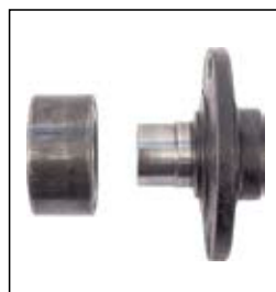
Dwuczęściowe standardowe łożysko koła
