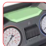
Kontrolka stanu pracy
